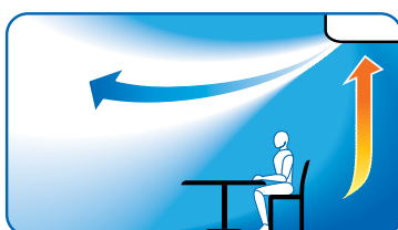
Mennyezeti készülékek esetén a légáram a légterelő zsaluk segítségével beállítható úgy, hogy az a személyek felett haladjon el.
